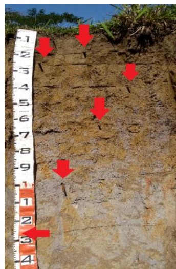
Figura 3 - Disposição das barras de ferro no P1. As setas indicam onde as barras foram inseridas. O sentido do caminhamento com o GPR foi da direita para esquerda
