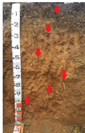
Figura 7 - Disposição das barras de ferro no P3. As setas indicam onde as barras foram inseridas. O sentido do caminamento com o GPR foi da esquerda para direita.
