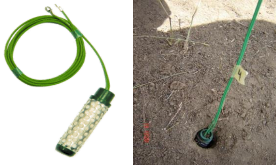
Figura 3: Sensor de Matriz Granular em detalhe (GMS) e GMS instalado no solo. Fonte: Imagem cedida pelo Laboratório de Geociências UERJ/ FFP (LABGEO)
