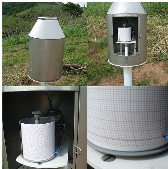
Figura 1: Pluviógrafo instalado na estação das parcelas de erosão. Fonte: Imagem cedida pelo Laboratório de Geociências da FFP – LABGEO.
