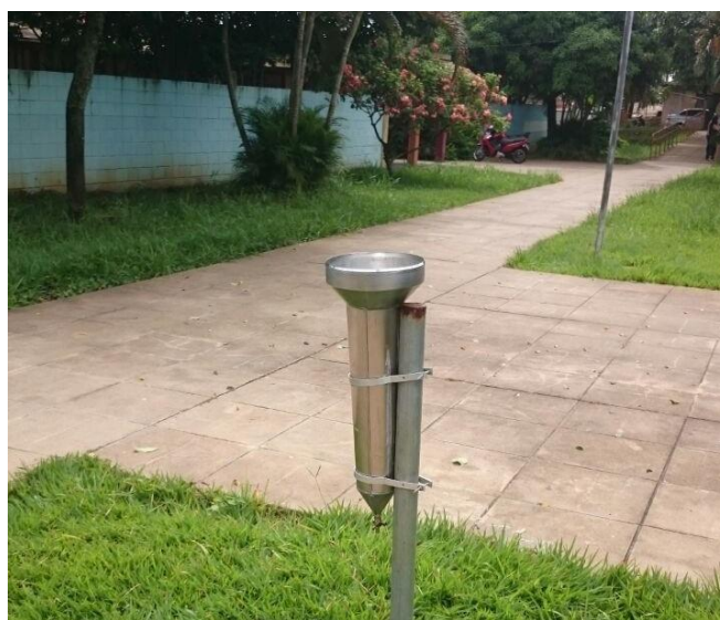
Figura 1 – Pluviômetro “ Ville de Paris ”
