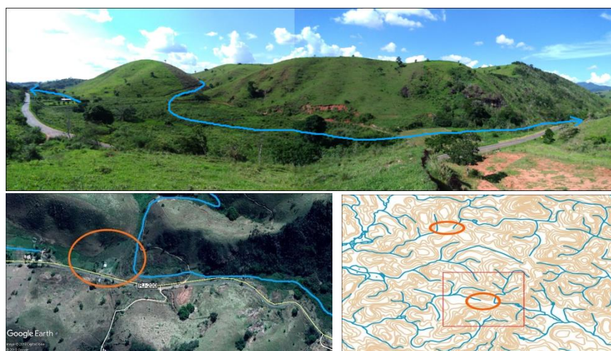
FIGURA 2 - a) Cotovelo com presença de vale seco b) imagem da captura por Google Earth. c) localização na carta topográfica.
