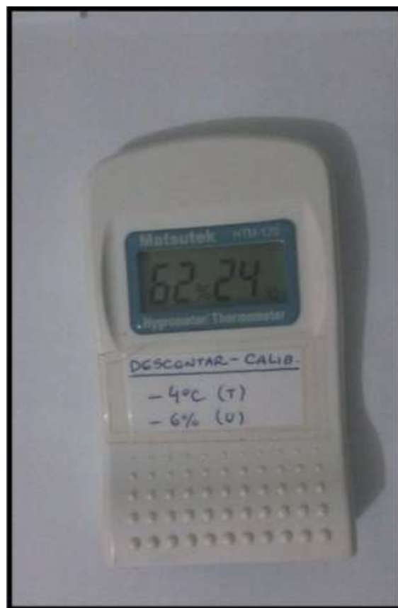
Figura 03: Termômetro eletrônico MATSUTEK HTM120
