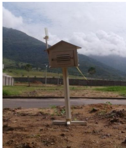
Figura 02 - Abrigo meteorológico utilizado na pesquisa em campo. Fonte: Autor, 2018.
