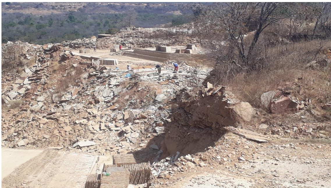
Figura 04 – Extração de rochas areníticas da Formação Cabeças Fonte: Pesquisa direta (2019).
