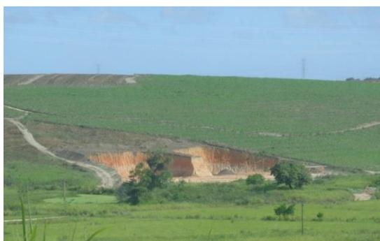
Figura 7 – Corte no talude para exploração do granito.
