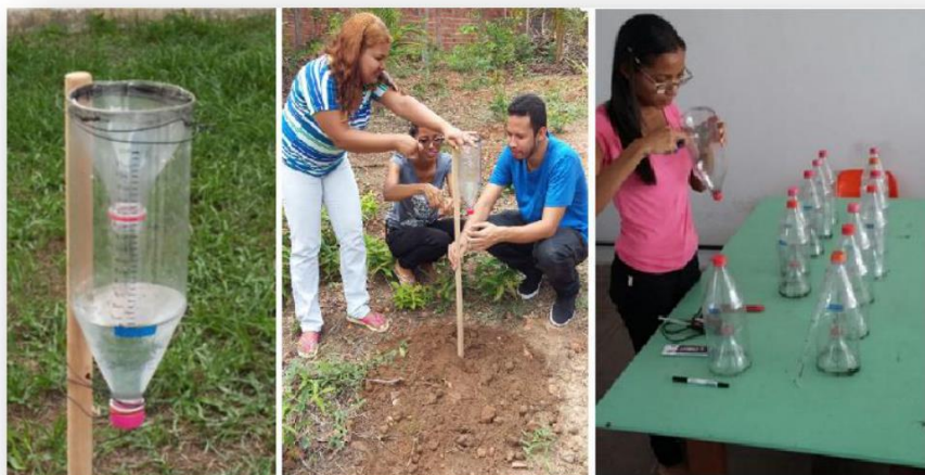
Figura 1: Instalação e confecção dos pluviômetros artesanais. Fonte: Santos, 2019.
