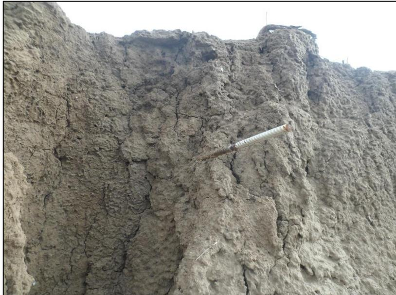
Figura 2 – Erosão por salpicamento registrada na seção Canelas I (março/2015).
