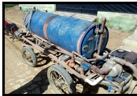
Figura 3- Moto pipa adaptado para o transporte e venda d'água na serra Fonte: Da autora, 2017.
